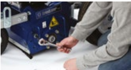
1. Vier Schrauben lösen
